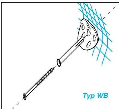
Die Wellung waagrecht am Putzgrund befestigen, wobei der waagerechte Kantendraht außen liegt. In der Regel sollten mind. 9 Dübel je m<sup>2</sup> verwendet werden. Minimale Putzüberdeckung 20 mm.
