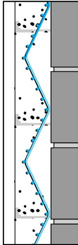
**CERABRAN® Welnet** ist ein geschweißtes, schlußverzinktes Drahtnetz das durch die Eigenart seiner Konstruktion den Dämmputz in seiner Gesamstärke trägt und armiert.
